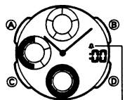
Индикатор подключения установки сигнала начала часа
