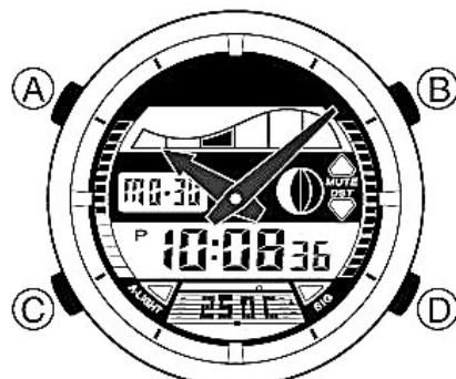
На рисунке изображен общий вид часов в Режиме Текущего Времени. Последовательное нажатие кнопки “C” обеспечивает переход из разряда в разряд в следующей последовательности: Режим Текущего Времени – Режим Лунного Времени – Режим Записной Книжки Температуры – Режим Секундомера – Режим Таймера Обратного Отсчета – Режим Звукового Сигнала – Режим Мирового Времени – Режим Аналогового Времени – Режим Текущего Времени.
