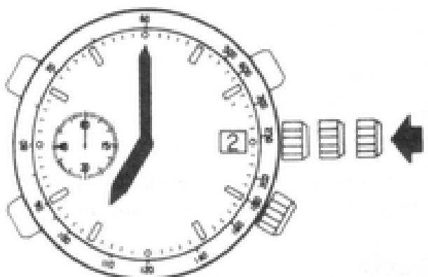
**5. Нажмите заводную головку ① в ее первоначальное положение в соответствии с сигналом точного времени. После этого часы запустятся.**
