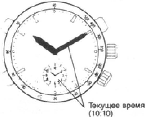
Если сигнализатор ВЫКЛЮЧЕН, часовая и минутная стрелки указывают текущее время.
