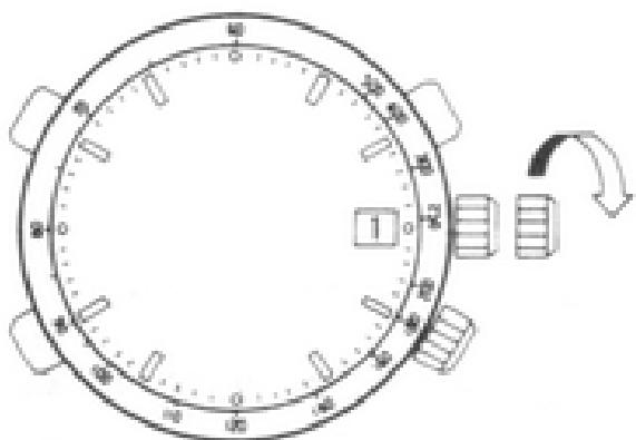
2. Установите дату для предыдущего дня путем поворота головки ② против часовой стрелки.
