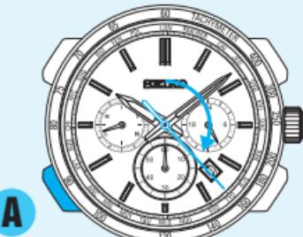
\* Если 1/5-секундная стрелка секундомера удерживается без движения в течение 10 или более секунд, часы автоматически переключаются в режим показа времени. В процессе выполнения повторите попытку начиная с Шага 1.
