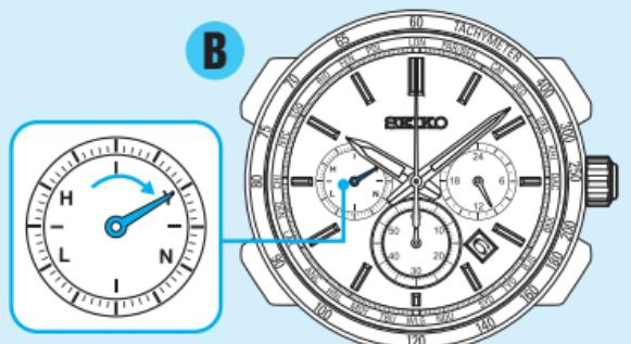
\* При нажатии и удерживании Кнопки B часы начинают принимать сигнал вручном режиме.
