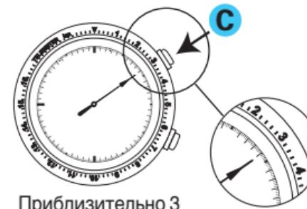
Обратите внимание, что 1/5 секундная стрелка секундомера движется с шагом в 1/5 секунду и не всегда точно указывает на отметку на шкале телеметра. Шкала телеметра может быть использована только тогда, когда измеряемое время составляет менее 60 секунд.
