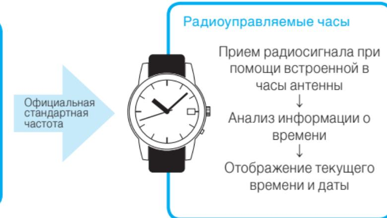
Сигнал времени, передаваемый на стандартной частоте, основывается на сверхточных “Цезиевых атомных часах”, точность хода которых составляет 1 секунду в 100 000 лет.
