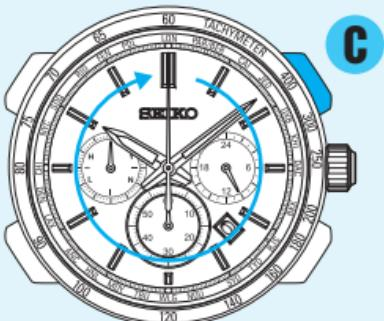
**3** Нажмите Кнопку D, чтобы установить 1/5-секундную стрелку секундометра в положение 0 секунд.
