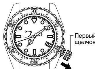
**ПРЕДУПРЕЖДЕНИЕ** Не забудьте зафиксировать заводную головку при использовании модели часов с заводной головкой с винтовым фиксатором.
