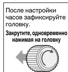
\* При блокировке заводной головки поворачивайте ее аккуратно, чтобы винт должным образом входил в зацепление с резьбой. Соблюдайте осторожность и не нажимайте на заводную головку с усилием, иначе можно повредить отверстие под винт в корпусе.
