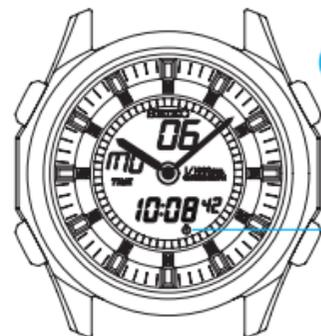
Индикатор часового сигнала времени (присутствует, когда часового сигнала времени и сигнала подтверждения для действий с кнопками включены)
