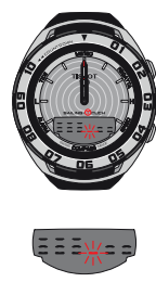
Мигающая колонка показывает, что в настоящий момент давление сильно изменяется (либо в сторону увеличения, либо в сторону снижения)
