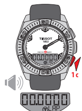
Возврат хронографа с функцией LAP в исходное положение осуществляется кнопкой -. Все зафиксированные значения будут оставаться в памяти часов до того момента, пока Вы не запустите хронограф снова.
