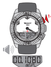
Время последнего результата следует остановить кнопкой ⊕
