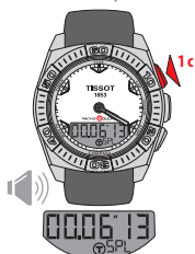
Запуск функции SPLIT хронографа осуществляется кнопкой ⊕
