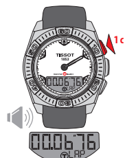
Запуск функции LAP хронографа осуществляется кнопкой +. Начинается отсчет времени первого промежуточного результата (круга).
