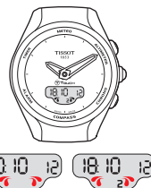
Стрелочная индикация, и T указывает время Вашей страны проживания Время T2 указывает время страны пребывания
