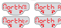
Выбор местного климата: T = умеренный; M = средиземноморский; A = сухой; tr = тропический; P = полярный
