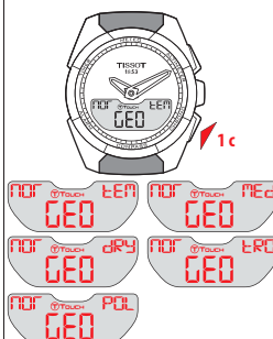
Выбор местного климата: tEM = умеренный / MEd = средиземноморский / dRY = пустынный / tRO = тропический / POL = полярный
