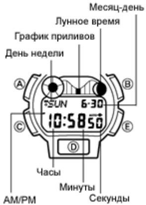
На рисунке изображен общий вид часов в режиме текущего времени. Нажмите кнопку "С" для перехода из режима в режим.
