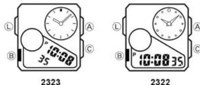
На рисунке изображен общий вид часов в режиме текущего времени. Нажмите кнопку "A" для перехода из режима в режим.
