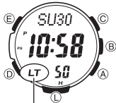
Индикатор включенной автоподсветки
