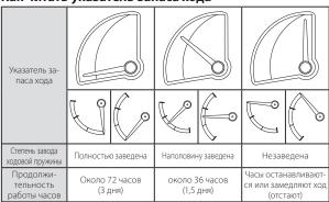
¾ Часы снабжены защитой против избыточного завода пружины. Когда ходовая пружина полностью заведена, она соскальзывает, отсоединяясь от заводного механизма. Таким образом, заводная головка может быть прокручена вперед без повреждения ходовой пружины. Тем не менее, постарайтесь воздержаться от избыточного завода пружины.
