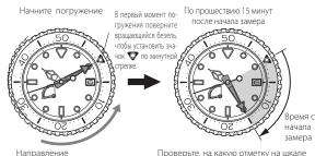
направление вращения безеля Проверьте, на какую отметку на шкале безеля указывает минутная стрелка.
