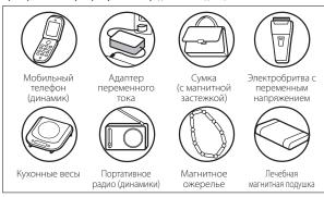
Детали часов могут намагнититься в зависимости от силы магнитного поля, в результате чего часы потеряют точность хода. В этой ситуации часы должны пройти процедуру размагничивания и настройки точности хода. Обратите внимание, что эта процедура платная, даже если она проводится до истечения гарантийного срока.
