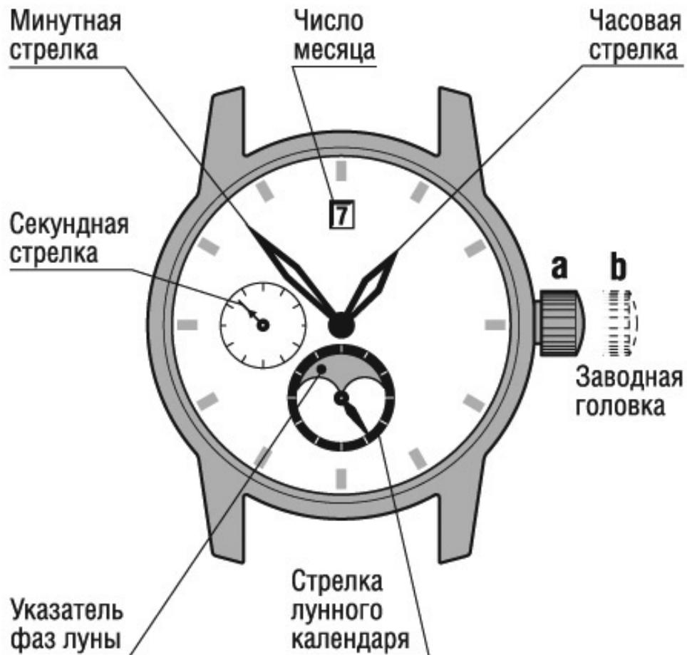
**Заводная головка часов имеет 2 фиксированных положения:**
