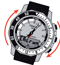
Поверните компас более чем на один оборот на горизонтальной поверхности (например на столе) в помещении без магнитных возмущений со скоростью вращения около 30° в секунду. Общая продолжительность: 20 секунд максимум
